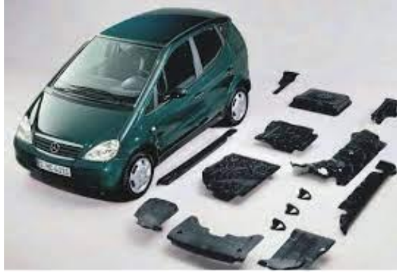
Şekil 1. 6. Mercedes Benz A-Class Arabada Cam Elyafın Yerini Almış Keten Elyaf-Polipropilen (PP) Kompozitler
