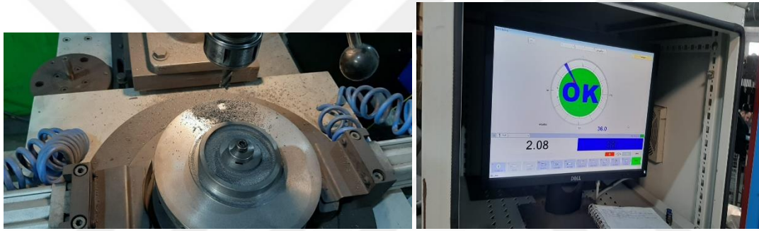
Şekil 5. 7. Malzemenin Balans Ayarı Yapıldıktan Sonraki Hali ve Mevcut Balans Değeri
