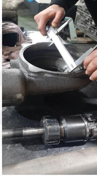
Şekil 5. 3. Salyangoz Parçanın İç Çapının Ölçülmesi
