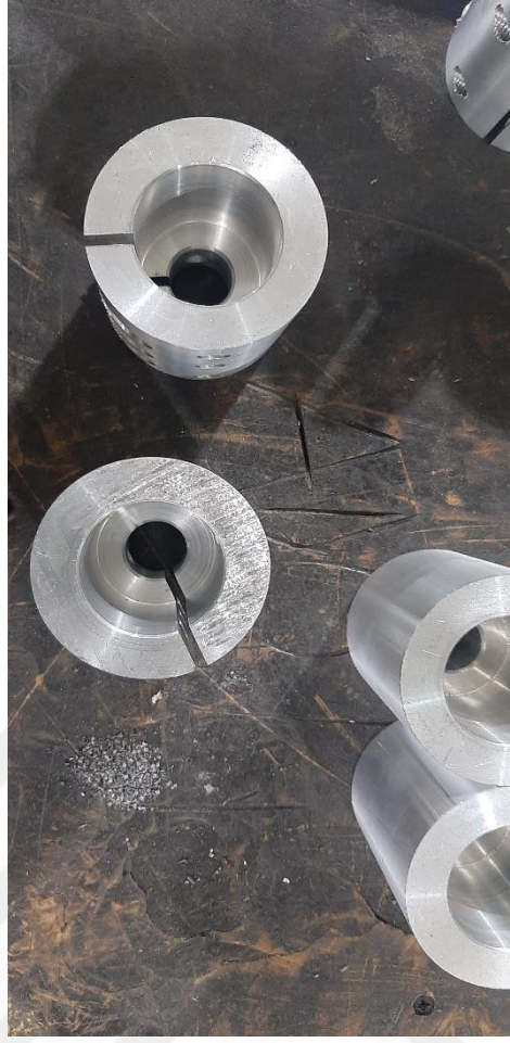
Şekil 5. 10. Boyu Hatalı Kesimi Yapılan Parça Örneği
