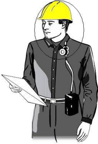
Şekil 20. Örnekleme başlığı ve pompanın konumu
