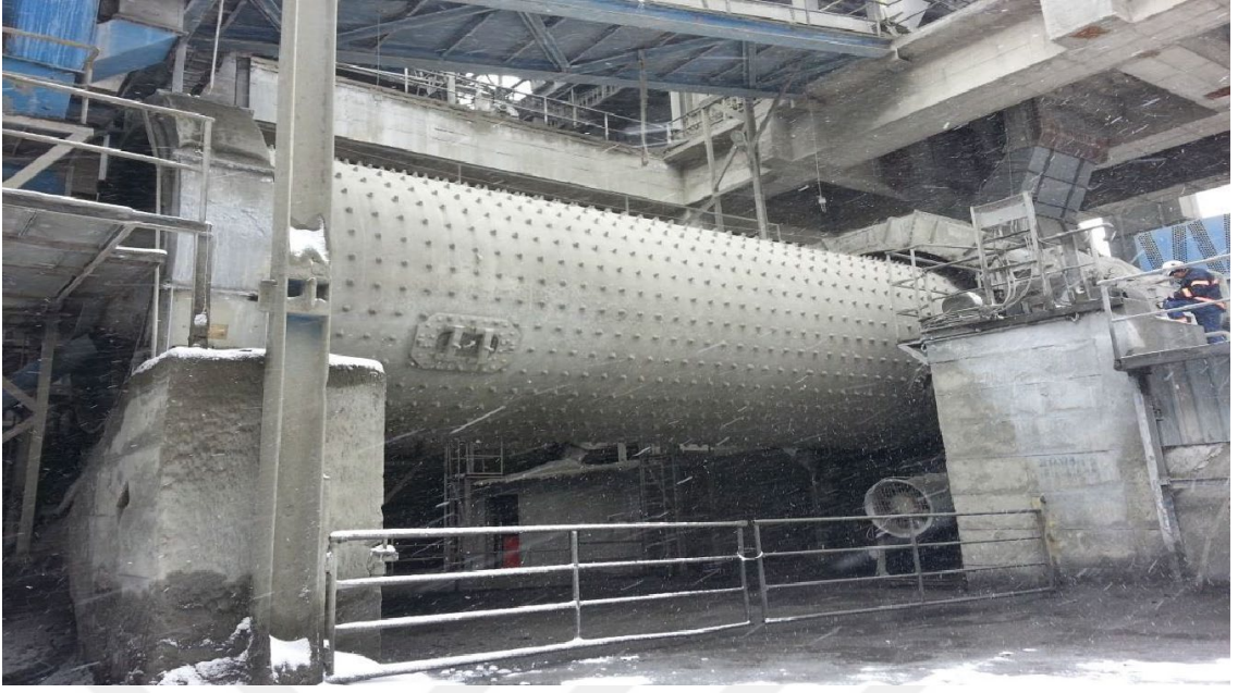
Şekil 12. Farinlerin ve katkı malzemelerinin karıştırıldığı çimento değirmeni
