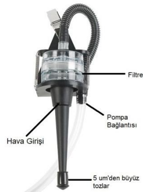
Şekil 18. Kişisel solunabilir toz örnekleme başlığı
