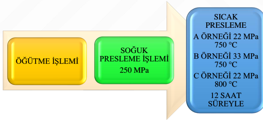
Şekil 4.10. Sıcak Presleme İşlem Sıralaması
