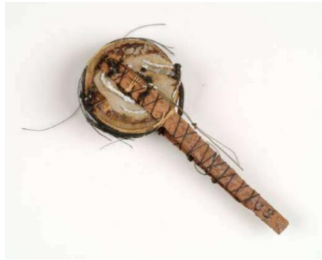
Şekil 1.1. Onnes Tarafından Yapılan İlk Süperiletken Bobin
