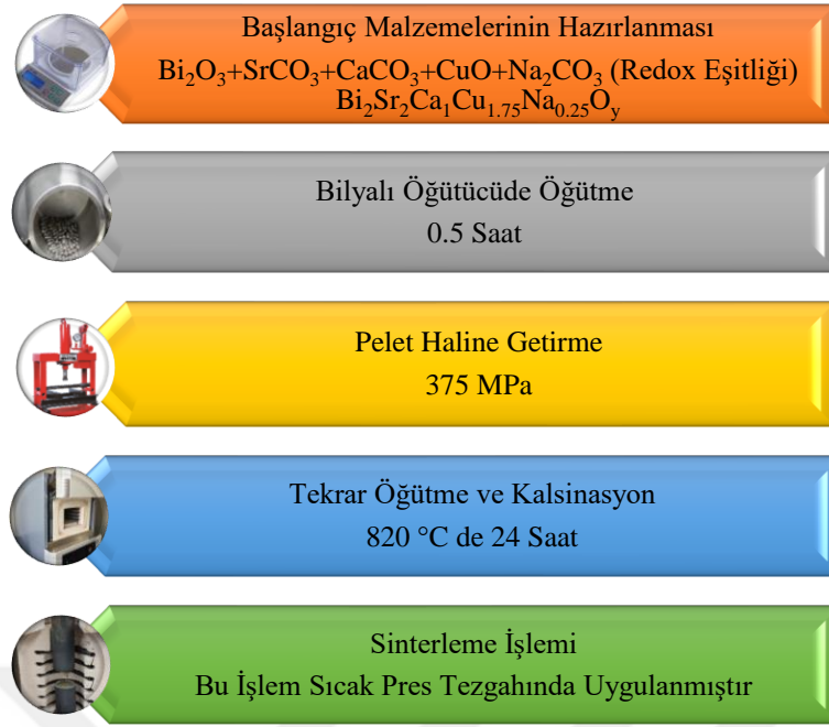
Şekil 4.8. Katı Hal Tepkime Yöntemi İşlem Sırası
