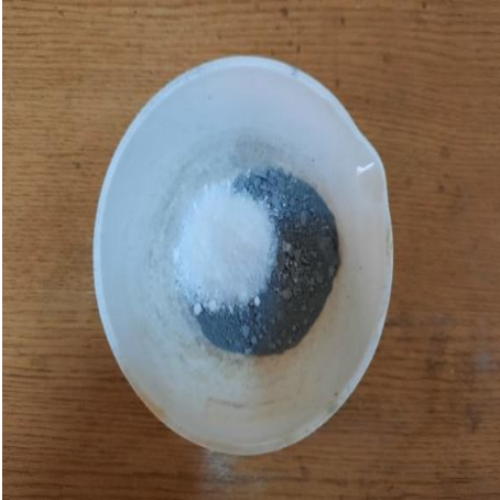
Şekil 4.12. \text{SiO}_2 İlave Etme İşlemi
