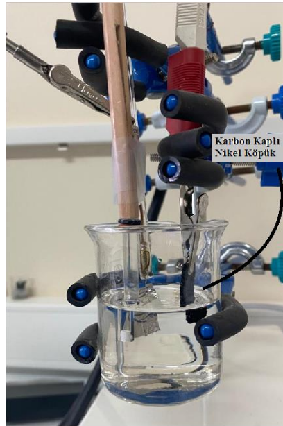
Şekil 4.25. Çalışmanın Yapıldığı Elektrot Düzenegi
