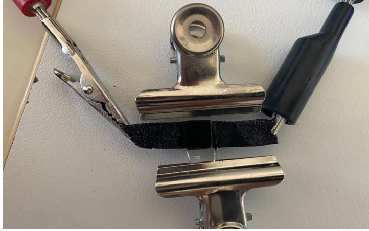
Şekil 4.36. Elektrokimyasal Ölçüm İçin Hazırlanan Simetrik Elektrotları İçeren İkili Hücre Mekanizması
