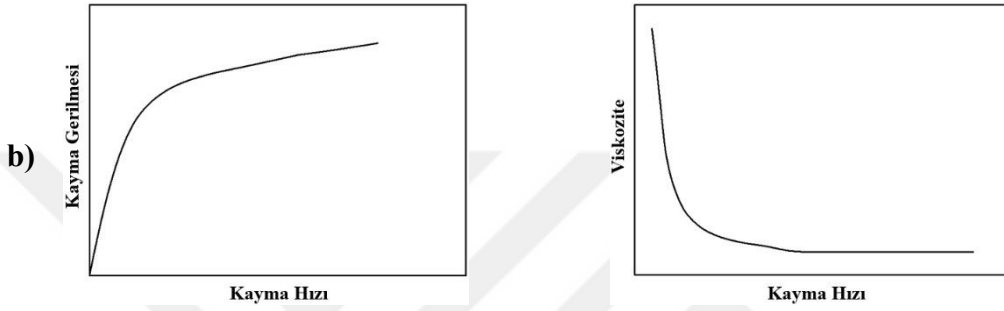
Şekil 1. 3. Newton tipi ve Newton tipi olmayan akışkanların kayma gerilmesi-kayma hızı ve viskozite-kayma hızı ile ilişkileri
