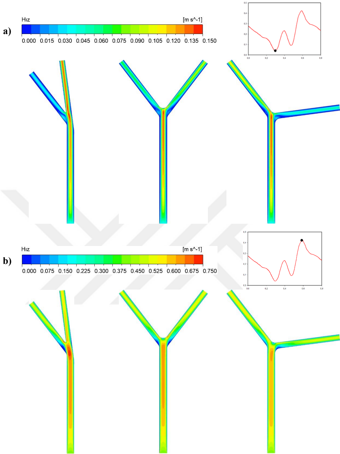
Şekil 4. 3. Sağlıklı durumdaki idealize arterlerin kardiyak döngünün a) minimum noktası ve b) maksimum noktasından elde edilen hız konturlarına ait görüntüler
