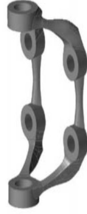
Optimize edilmiş yük taşıma aparatı
