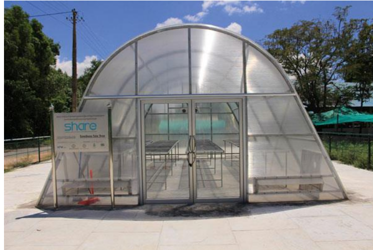
Şekil 2.13. Kamboçya'daki Kraliyet Tarım Üniversitesi'ne kurulan güneş enerjisi sera kurutucusu (Fotoğraf: J. Banout).
