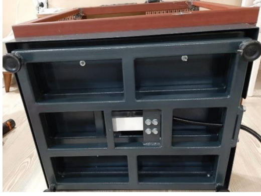
Şekil 3.12. Tartım platformu ve ağırlık ölçerin montaj edilmiş görünümü.
