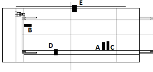
Şekil 3.11. Kurutma kabininin üstten görünüşü. (A ve B: kabin içi sıcaklık algılayıcıları, C: kabin içi nem algılayıcı, E: emiş fanı ve D: hava deliği).
