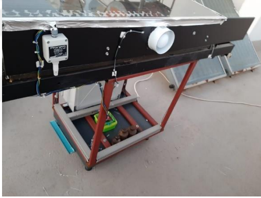
Şekil 3.13. Kurutma sisteminin arkasında nemölçer ve emiş fanı ile birlikte arkadan görünüşü.
