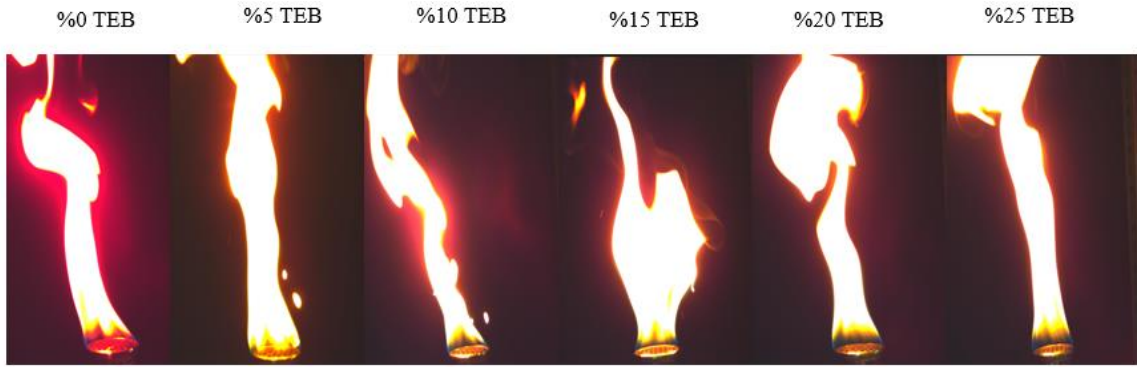
Şekil 4.26. Meker-Fisher Bekinde 4.5 lt/dk Debide Difüzyon Yanma
