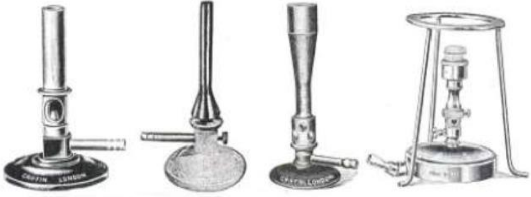
Şekil 3.12. Bunsen Beki, Teclu Beki, Meker Fisher Beki ve Ocak Tipi Bek Düzeneği
