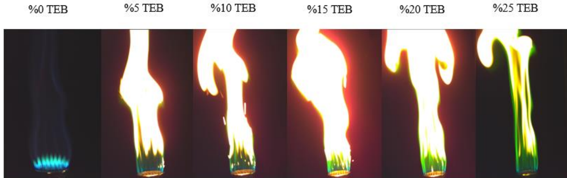
Şekil 4.21. Meker-Fisher Bekinde 7.5 lt/dk Debide Ön Karışımli Yanma
