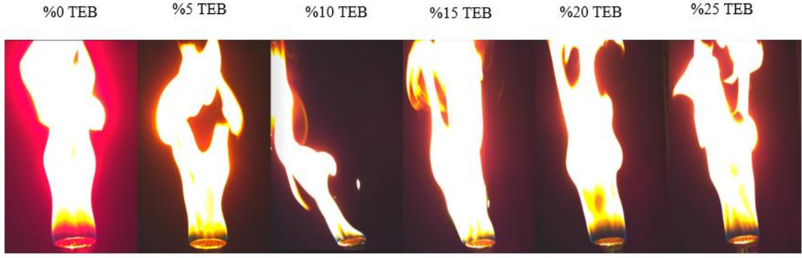
Şekil 4.27. Meker-Fisher Bekinde 7.5 lt/dk Debide Difüzyon Yanma
