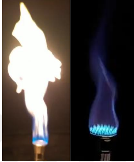
Şekil 2.6. Difüzyon ve Ön Karışımli Yanmanın Deneysel Görüntüsü
