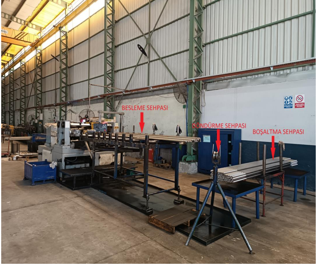
Şekil 4.4.1.12. Ankraj Diş Açma Tezgâhı Çalışma Öncesi Durum
